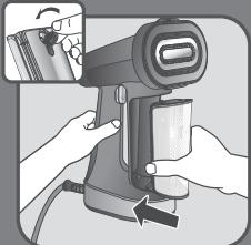
**FR** Remettez le réservoir d'eau à sa place dans l'appareil. Assurez-vous que le réservoir d'eau est bien remis en position.
