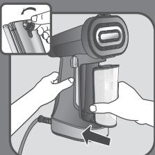
FR Replacez le bouchon et remettez le réservoir d'eau à sa place. Veillez à ce que le réservoir d'eau soit bien mis en place.
