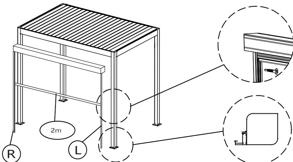
Le rail du Rideau « L/R » doit être installé à l'extérieur du poteau de support plat
