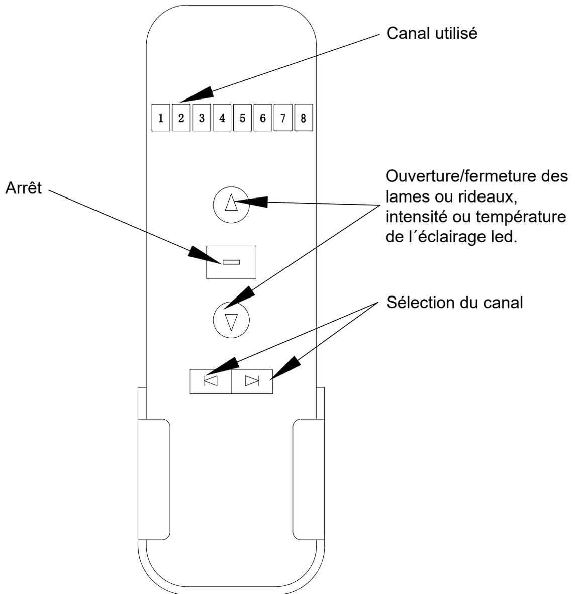
La télécommande est fournie avec une pile CR-2032. Elle fonctionne sur la fréquence 433,92 MHz. Sa portée maximale est d'environ 40-50 m suivant l'environnement.
