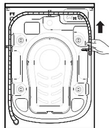
**11** Connectez le tuyau de vidange au Vidange ou accrochez-le au bord d'un évier au moyen du coude en « U ». Installez le coude en « U » E, s'il n'est pas déjà installé, à l'extrémité du tuyau de vidange.
