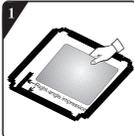
Avant d'installer la plaque inférieure antibruit, alignez et collez la laine d'absorption acoustique avec et le long de l'impression d'angle droit sur la plaque inférieure (cette procédure n'est pas nécessaire pour certains modèles sans laine d'absorption acoustique).
