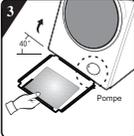
Inclinez la machine à un angle de 40° et laissez le côté avec la face d'encoche à angle droit vers l'avant de la machine à laver, comme illustré dans la figure. Insérez le côté avec l'encoche à angle oblique entré deux vis de pied à l'arrière de la machine à laver complètement en place. Ensuite, installez la plaque inférieure et assurez-vous qu'elle est en contact étroit avec le fond de la machine à laver.
