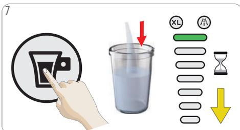
7 Appuyez sur le bouton marche/arrêt. Le rinçage démarre. Attendez que la machine s'arrête automatiquement. Le bouton de sélection de la température ainsi que le témoin lumineux de l'afficheur de volume clignotent pendant 8 s max.
