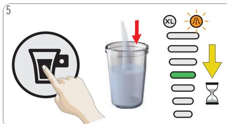
5 Appuyez sur le bouton marche/arrêt. Le détartrage démarre. Les barres de l'afficheur de volume clignotent du haut vers le bas jusqu'au 4<sup>e</sup> niveau. La machine se détartré à l'eau chaude en mode marche/arrêt. La phase de détartrage s'arrête lorsque le réservoir d'eau est vide.
