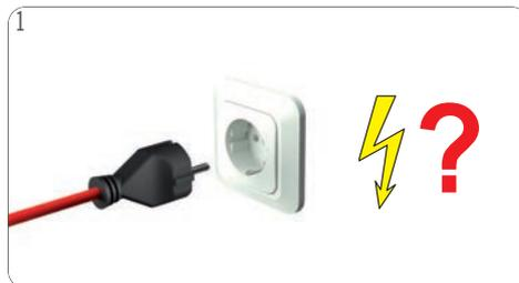
1 Vérifiez si la fiche de courant est correctement branchée sur la prise. Si oui, vérifiez l'alimentation électrique.
