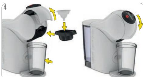
Ouvrez la poignée de verrouillage. Placez l'accessoire de rinçage dans le porte-capsule. Insérez le porte-capsule dans la machine. Fermez la poignée de verrouillage. Enlevez le bac d'égouttage. Placez un grand récipient vide sous la sortie café.
