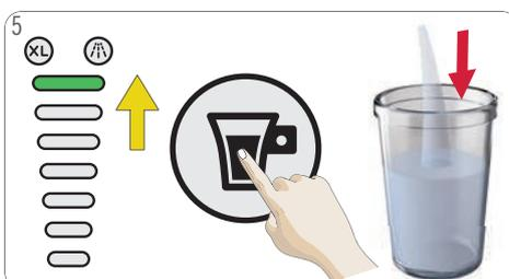
Utilisez la bague de commande et sélectionnez le niveau 7 de l'afficheur de volume (barre tout en haut). Appuyez sur le bouton marche/arrêt. Le rinçage démarre.
