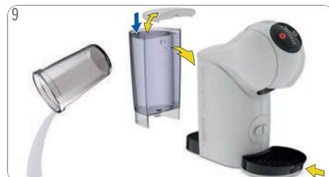
9 Videz le récipient. Versez de l'eau potable fraîche dans le réservoir. Insérez le réservoir dans la machine. Remettez le bac d'égouttage en place. La machine est opérationnelle.
