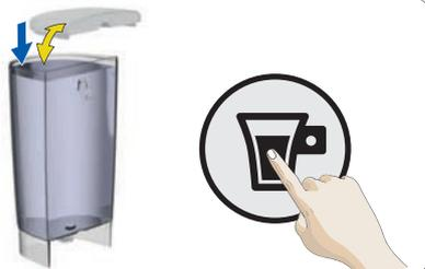
Vérifiez si le réservoir d'eau contient assez d'eau fraîche. Si ce n'est pas le cas, ajoutez de l'eau potable fraîche et appuyez sur le bouton marche/arrêt pour continuer la préparation. S'il n'y a toujours pas de sortie de liquide, allez à l'étape 10.3 « AUCUN LIQUIDE NE SORT – CAPSULE BOUCHÉE ? ».
