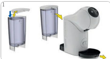
1 Versez de l'eau potable fraîche dans le réservoir. Réintroduisez celui-ci dans la machine. Enlevez le bac d'égouttage.
