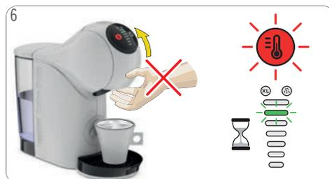
6 À la fin de la préparation, le bouton de sélection de la température et la lumière de l'afficheur de volume clignotent pendant 8 s max. **Durant ce temps, n'ouvrez pas la poignée de verrouillage !**
