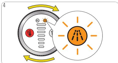
4 Pour accéder au mode détartrage, sélectionnez XL et tournez la bague de commande quatre fois dans le sens horaire jusqu'à ce que la LED de détartrage se mette à clignoter.
