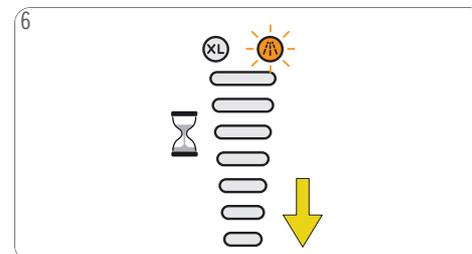
6 Pour permettre un détartrage plus efficace, la machine reste dans ce mode pendant env. 2 minutes. L'afficheur de volume indique la progression, du haut vers le bas.
