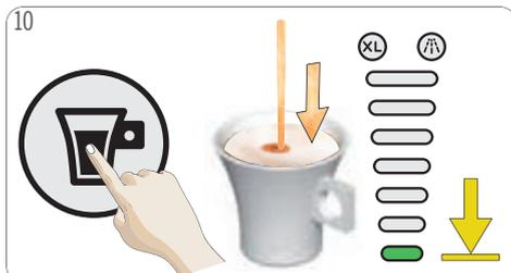
Appuyez sur le bouton marche/arrêt. La préparation de la boisson commence. **N'ouvrez pas la poignée de verrouillage pendant l'extraction.** Attendez la fin de l'extraction. La machine arrête la préparation automatiquement. L'extraction peut être arrêtée manuellement à tout moment par pression du bouton marche/arrêt.
