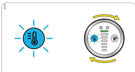
**Option C :** Boisson chaude préparée ou mode Froid non sélectionné dans un délai de 10 s après le démarrage de la machine. Appuyez sur le bouton de sélection de température pour activer le mode Froid. Le bouton de sélection de la température clignote en bleu pour indiquer que la machine doit refroidir.
