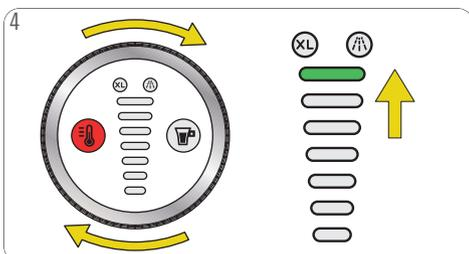
4 Utilisez la bague de commande et sélectionnez le niveau 7 de l'afficheur de volume (barre tout en haut).
