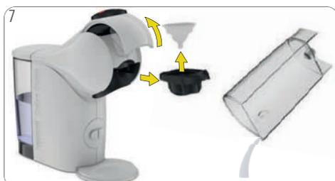
Ouvrez la poignée de verrouillage. Sortez le porte-capsule. Enlevez l'accessoire de rinçage. Placez-le en lieu sûr pour un nettoyage ou un détartrage ultérieurs. Si le réservoir contient de l'eau, videz-le.
