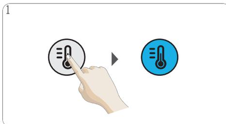
Appuyez le bouton de sélection de la température pour démarrer la machine en mode Froid. Une boisson froide peut être préparée immédiatement.
