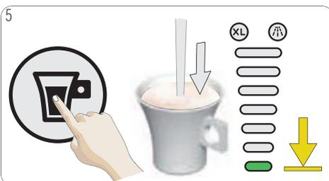
5 Appuyez sur le bouton marche/arrêt. La préparation de la boisson commence. **N'ouvrez pas la poignée de verrouillage pendant l'extraction.** Attendez la fin de l'extraction. La machine arrête la préparation automatiquement. L'extraction peut être arrêtée manuellement à tout moment par pression du bouton marche/arrêt.
