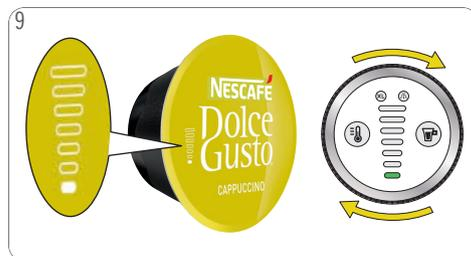
9 Utilisez la bague de commande pour régler le volume conformément au nombre de barres indiqué sur la capsule, ou bien réglez le volume selon votre propre goût.
