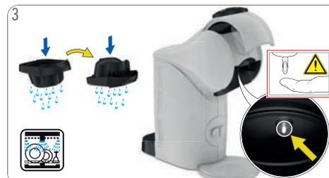
Nettoyez avec un détergent liquide et de l'eau potable fraîche les deux côtés du porte-capsule. Ou lavez-le dans un lave-vaisselle. Essayez-le ensuite. Nettoyez la tête de la machine autour de l'injecteur à l'aide d'un chiffon doux humide.
