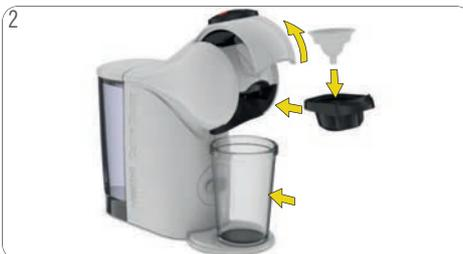
2 Ouvrez la poignée de verrouillage. Placez l'accessoire de rinçage dans le porte-capsule. Insérez le porte-capsule dans la machine. Placez un grand récipient vide sous la sortie café.
