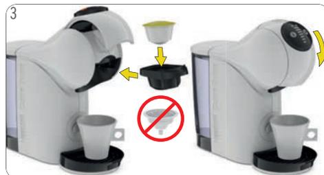
3 Assurez-vous que l'outil de rinçage n'est pas à l'intérieur. Insérez une première capsule dans le porte-capsule. Réintroduisez celui-ci dans la machine. Fermez la poignée de verrouillage.
