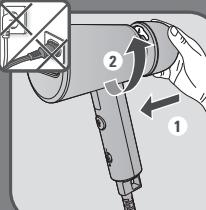
مخزن آب را با پیچاندن آن مطابق عالمت دوباره سر جای خود قرار دهد تا کاملاً در حایش قرار بگیرد. مطمئن شوید که مخزن آب کاملاً در حایش قرار گرفته باشد.
