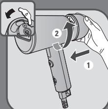
**ES** Cierre la tapa de la entrada de agua. Vuelva a colocar el depósito de agua en su posición dentro del aparato, asegurándose de que está totalmente insertado en su posición.
