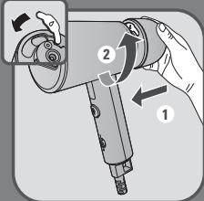
**EL** Τοποθετήστε την τάπα στο δοχείο νερού. Τοποθετήστε το δοχείο νερού στη συσκευή και βεβαιωθείτε ότι έχει εφαρμόσει σωστά.
