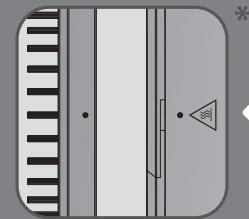
نقطه نشانگر روی برس را با نقطه نشانگر روی دستگاه هم تراز کنید و مطمئن شوید که برس ضخیم کاملاً متصل شده باشد.
