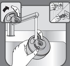
**RU** Нажмите кнопку подачи пара. Дайте устройству поработать, пока резервуар для воды полностью не опустеет.
