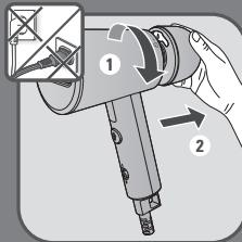
**RO** Scoateți rezervorul de apă, deșurubându-l conform marcapoziției.
