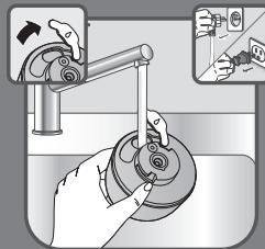
**RO** Clătiți rezervorul de apă. Odată clătit, umpleți rezervorul cu 100% apă. Închideți capacul orificiului de admisie a apei.
