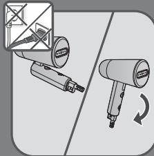
همیشه قبل از هر بار استفاده از دستگاه، سری بخار را باز کنید تا در جای خود قفل شود. وقتی دستگاه تاشده است هرگز از بخار استفاده نکنید.
