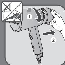
مخزن آب را باز کردن پیچ آن مطابق علامت باز کنید.
