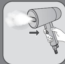
**DA** Vent mindst 25 sekunder, før du trykker på damp-knappen. Lysindikatoren slukker, når produktet er klar til brug. Lad apparatet køre, indtil vandbeholderen er helt tom.
