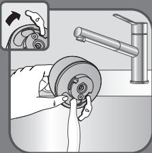
**EL** Ανοίξτε το πώμα ανοίγματος εισόδου νερού και αδειάστε τελείως το δοχείο νερού.
