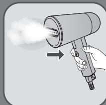
**RO** Apăsați pe butonul de comandă a aburului. Lăsați aparatul să funcționeze până când rezervorul de apă se golește complet.
