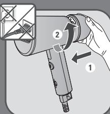
**DA** Sæt vandbeholderen på plads igen ved at skru den på, som markeringen viser, indtil den sidder helt fast. Sørg for, at vandbeholderen sidder rigtigt på apparatet.
