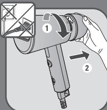
**RO** Scoateți rezervorul de apă, deșurubându-l conform marcajului.
