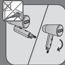
**DA** Fold altid dampmundstykket helt ud, indtil det låses fast, inden apparatet tages i brug. Brug ikke damp, når apparatet er foldet sammen.
