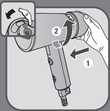
**RO** Închideți capacul orificiului de admisie a apei. Puneți rezervorul de apă în locașul său pe aparat și apoi asigurați-vă că este complet introdus în locașul său.
