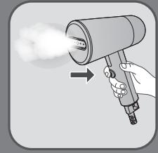
داقل 25 ثانية صبر کنید و بعد دکمه بخار را فشار دهید. وقتی دستگاه آماده شود لامپ نشانگر خاموش می‌شود. دکمه بخار را فشار دهید. بگذارید دستگاه کار کند تا وقتی مخزن آب کاملاً خالی شود.
