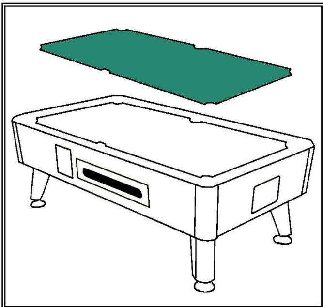
2. Dévissez les vis placées sur les rails et retirez le dessus. Mettez l'ardoise dans la caisse.
