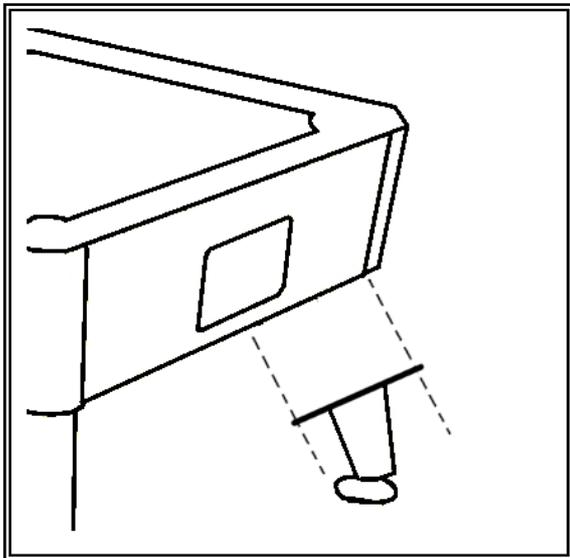
1. Placez d'abord la table sur un côté long et fixez les pieds à la table à l'aide des boulons TE 8x 40.
