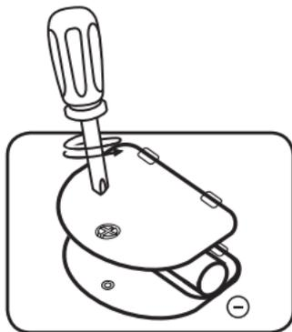
5. Refermer soigneusement le couvercle du compartiment à pile et s'assurer que la vis est bien serrée.
