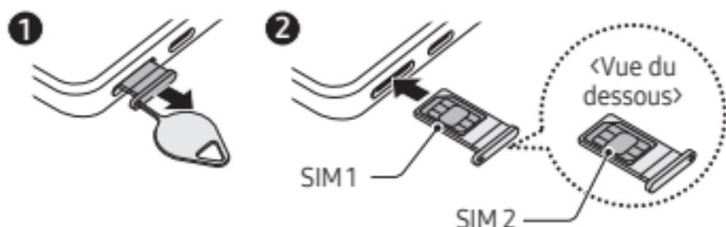
Insérez l'outil de retrait à l'emplacement prévu à cet effet sur le compartiment pour le retirer.
