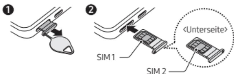
Führe das Steckplatzwerkzeug in die Öffnung des Kartenhalters ein, um ihn zu entfernen.
