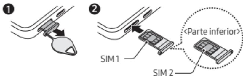
Para extraer la bandeja, introduzca la anilla de extracción en el orificio de la bandeja.
