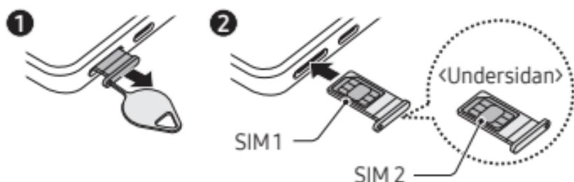
Stick in utmatningsverktyget i hålet i facket för att lossa facket.
