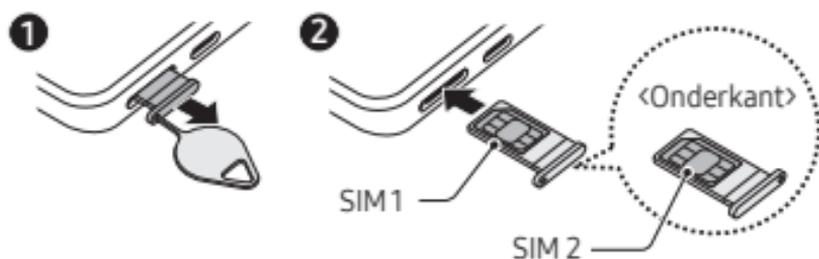
Steek de pin voor uitwerpen in het gaatje op de lade om de lade te verwijderen.
