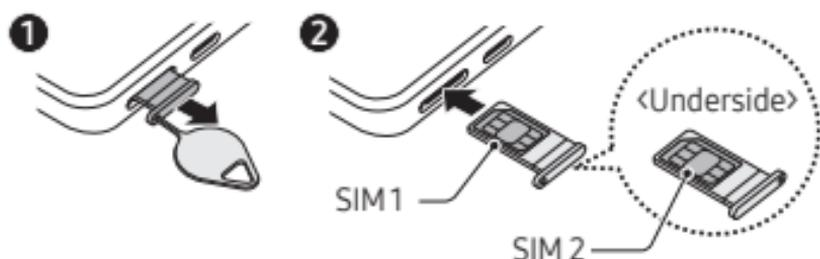
Sæt udskubningsstiften i hullet på holderen for at frigøre holderen.
