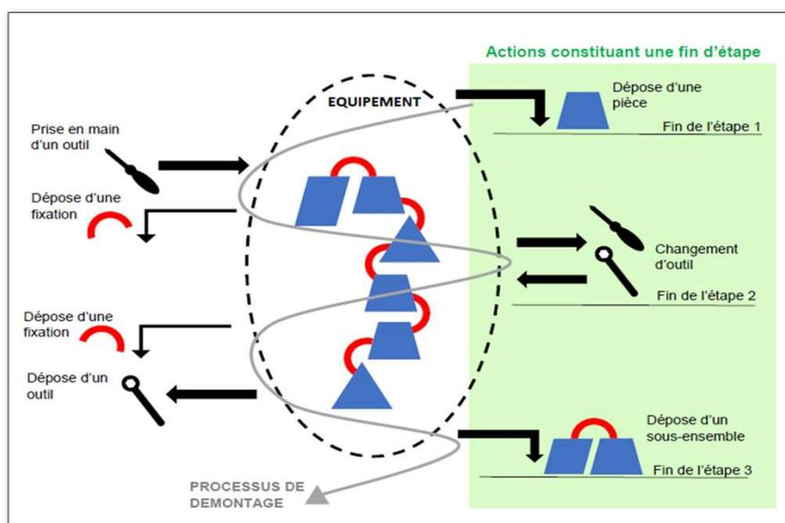
Figure 1 - Exemple d'un processus de démontage
