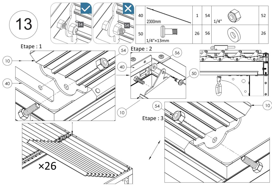
Attention : veiller à serrer modérément les écrous afin de ne pas entraver le bon fonctionnement du mécanisme
