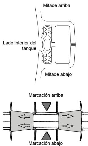
Para fijar las dos partes fije un conector en forma de clip de manera intercalada a la derecha y a la izquierda. Para ello ajuste primero cada segundo conector con la mano y en seguida con un martillo y una base de madera. Para facilitar el montaje, engrase los conectores en los bordes interiores. Encage los conectores en la posición definitiva.
