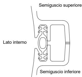
Per collegare i due semigusci montare i raccordi rapidi prima verso destra e poi verso sinistra. Per facilitare il montaggio potrebbe essere necessario premere assieme i due semigusci mediante una serie di griffe. A tal scopo posizionare ca. 3 – 4 griffe sul bordo del serbatoio e serrarle uniformemente lungo l'intero perimetro.
