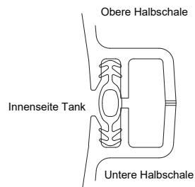
Zur Verbindung der Schalen werden die Schnellverbinder erst linksherum und anschließend rechtsherum angebracht. Um die Montage zu erleichtern kann es notwendig sein, beide Halbschalen mit mehreren Schraubzwingen zusammenzudrücken. Dazu ca. 3-4 Schraubzwingen am Behälterrand verteilen und umlaufend gleichmäßig anziehen.
