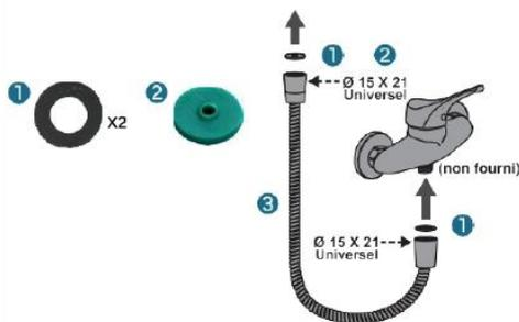
À n'utiliser que dans des installations ayant un minimum de pression de 1 Bar.
